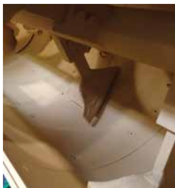
Spezielle verschleißfeste Mischkammerauskleidung
