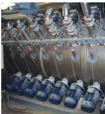
Messerköpfe, Flüssigkeitszugablenze, Doppelmantel
